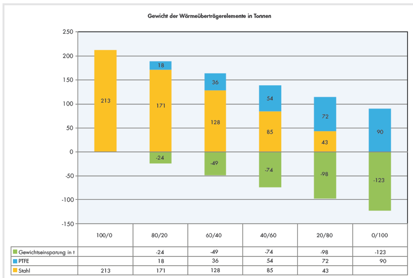
Bild 9. Das Potenzial zur Gewichtsreduzierung von Ljungström-Rotoren durch Ersatz der Metallpakete mittels PTFE-Waben – bei gleicher Wärmeübertragungskapazität – ist signifikant: Am Beispiel eines D = 20-Meter-Rotors mit einer Bestückungshöhe von einem Meter wird das Gewicht der bewegten Masse bei vollständigem Ersatz der Metallblechbestückung durch PTFE-Waben um ca. 125 t gesenkt: von links nach rechts: sukzessiver Ersatz der Metallblechbestückung durch PTFE-Waben
