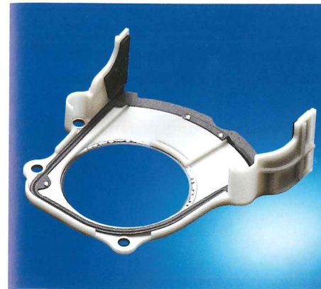
Bild 2. Dieses Bauteil wird in Gehäusedeckeln im Motorraum eines Fahrzeugs verbaut. Es besteht aus einem Frontdeckel aus 30 % glasfaserverstärktem Polyamid mit einer umspritzten Dichtlippe aus PTFE-Compound. Außerdem enthält es metallische Einleger und ist für schnelle Montage ausgelegt (© ElingKlinger Kunststofftechnik)
