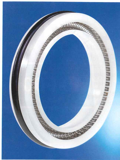
Bild 1. Eine federunterstützte Dichtung für ein Kugelsegment, das in Kühlwasserkreisläufen zur Anwendung kommt. Sie besteht aus modifiziertem PTFE, wird via Spritzgießen verarbeitet und demonstriert die Einsatzmöglichkeiten dieses Materials – auch für medizinische Bereiche (© ElingKlinger Kunststofftechnik)
