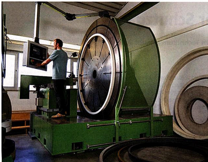
Dichtungen bis zu einem Durchmesser von 3 m lassen sich spanabhebend aus einem Stück fertigen. Als Werkstoffe haben sich insbesondere Compounds auf Basis von modifiziertem PTFE bewährt.
